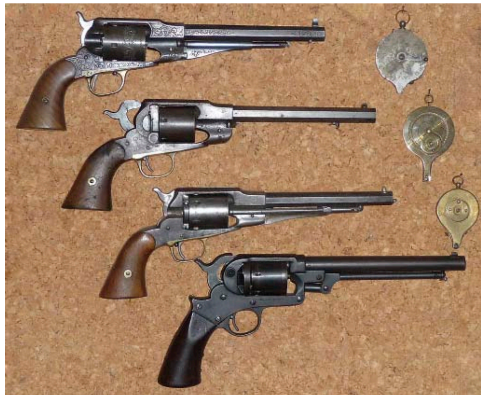
Verschieden konvertiert. Von oben: Zu sehen sind Arsenal- und Büchsenmacher-Conversions. Zwei Remington Armys und darunter eine Remington Navy sowie eine Starr SA Army Conversion.
